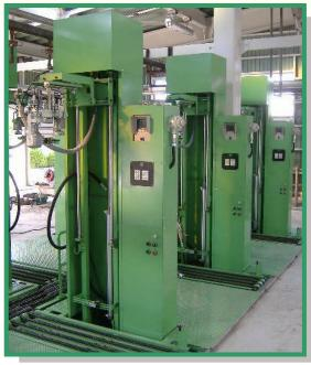
充填バルブをセットすると CPUの指示により 自動充填を行います。
